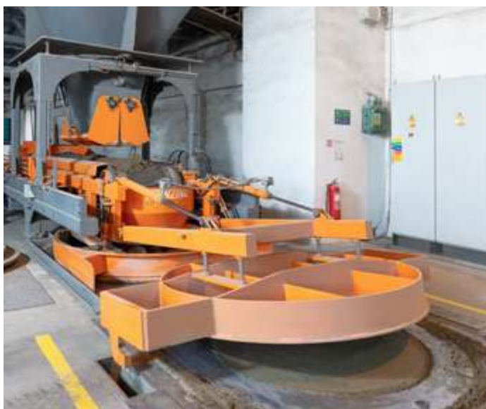
Proces výroby polotovaru systémem vibrolisování
