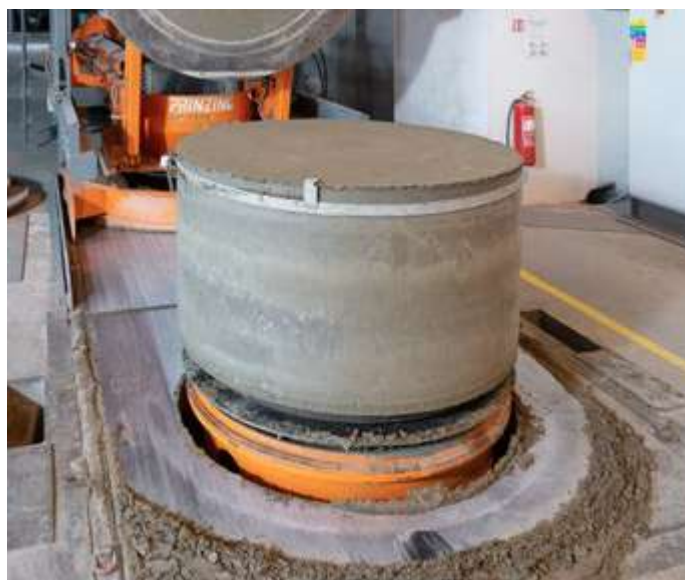
Hotový vibrolisovaný polotovaz šachtového dna – výroba v obrácené poloze
