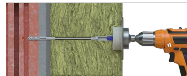
6. Montáž hmoždinky. Při montáži netlačit na tool OPTI!
