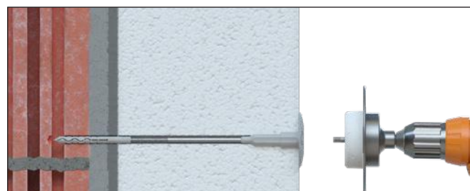
5. Nasazení zátky EPS-QUICK na tool OPTI
