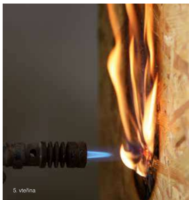
Obrázek 21 Použitím desek OSB Firestop lze prodloužit dobu do celkového vzplanutí z několika mála minut až na desítky minut.
