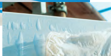
Použití samolepicí ochranné fólie na anodizovaném hliníku není bez bublin a drobných záhybů.
