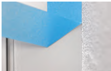
Přilnutí na anodizovaný hliník beze stop lepidla s páskou tesa Precision Mask® 4440 Outdoor UV PLUS
