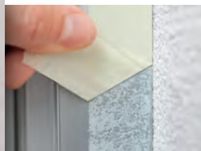
Zbytky lepidla na anodizovaném hliníku.
