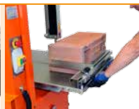
Bezpečné použití - čidlo na doraz stolu
