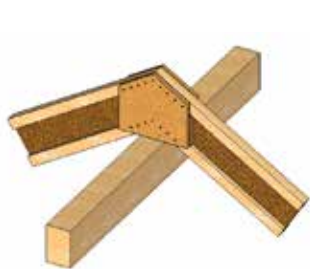
Konstrukce krovu s vrcholovou vaznicí
